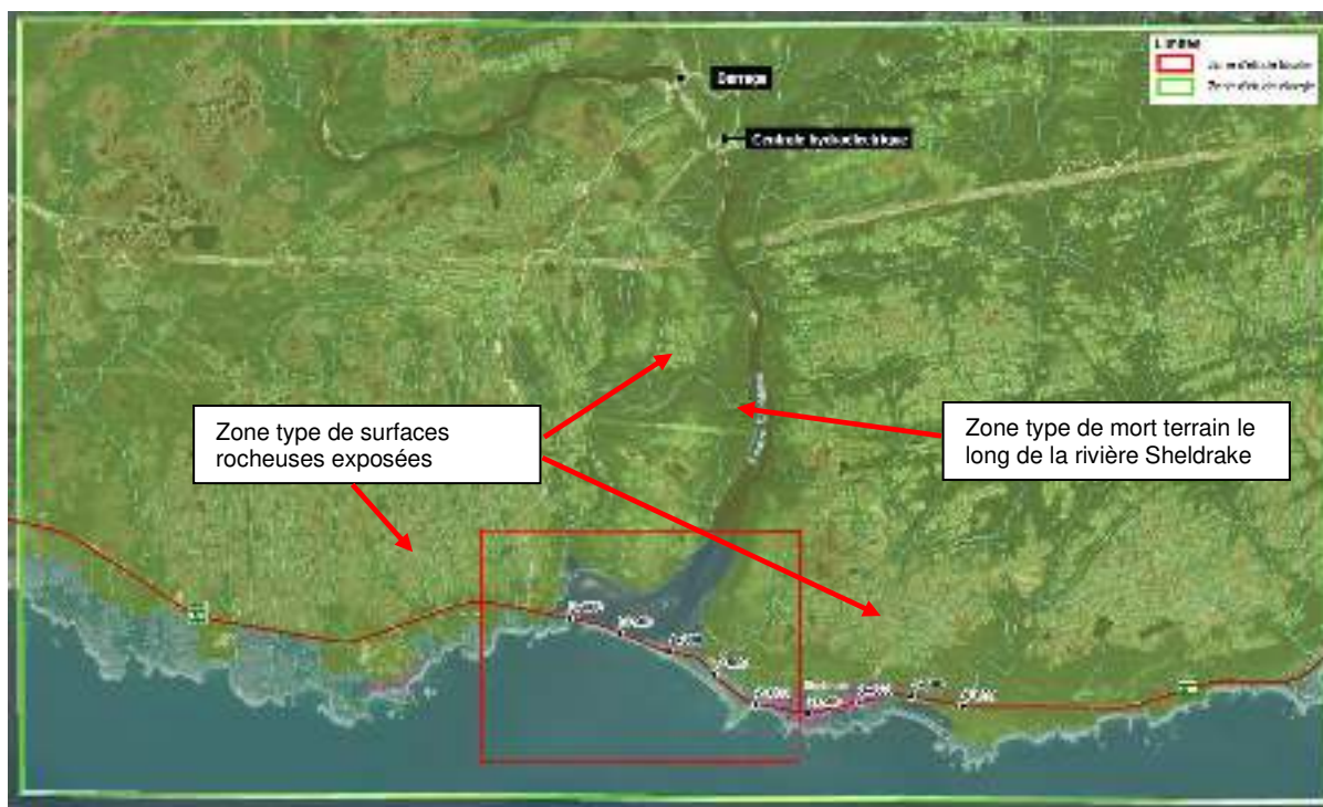
Figure 4-1 Zone d'étude pour la relocalisation de la route 138 et caractérisation des couches de surface
