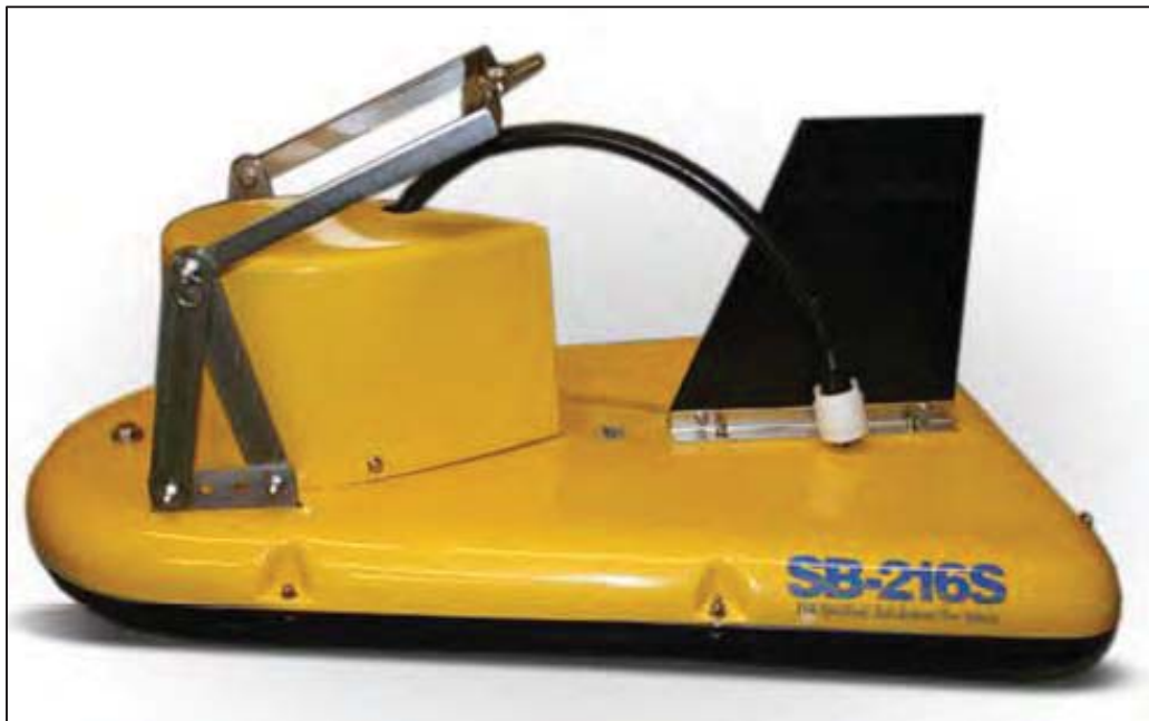
Figure 2-36 Profileur de sous-surface (PSS) de marque EdgeTech© modèle 3100 216S
